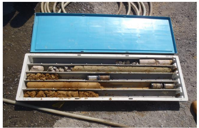
大台北備災中心地質鑽探土壤取樣圖
